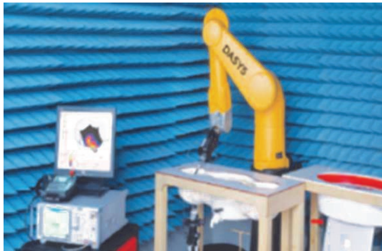
Figur 2: Roboterarm mit Sonde zur Messung des elektrischen Feldes Quelle: Speag DASY 52 Info-Blatt
